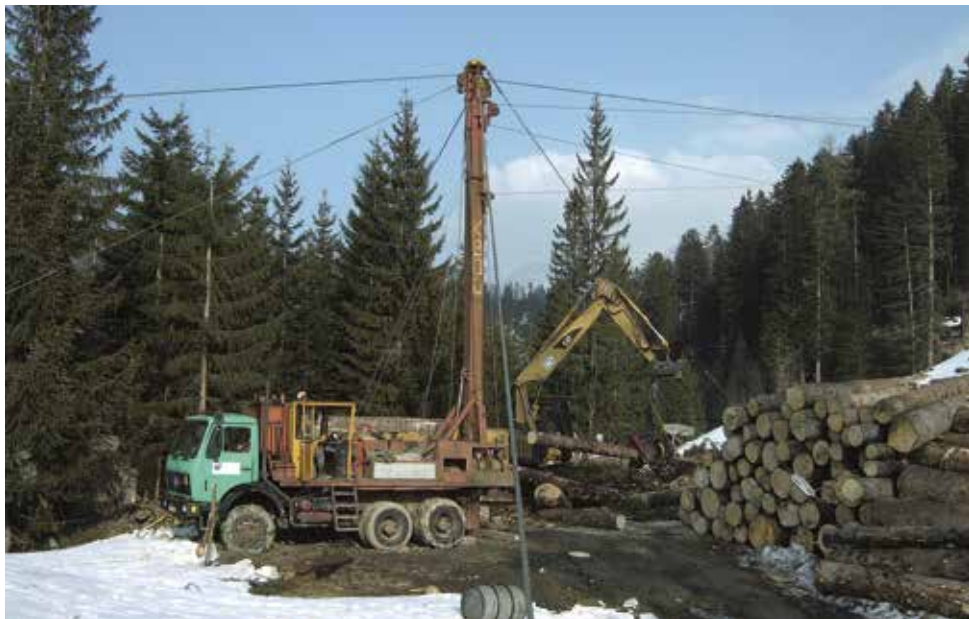
Revierleiter Dinger beobachtet die Bringung von Borkenkäferholz per Hubschrauber vom Gerhardstein, 2011 Seilbringung mit Baggerharvesteraufarbeitung (K800), Aiblkapelle, 2007
