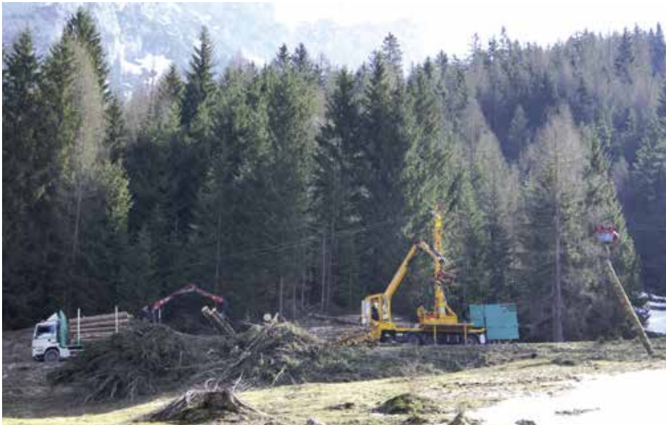
Moderne Seilbringung, Harvesteraufarbeitung und Abtransport per LKW, 2012
